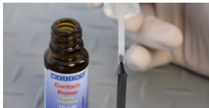
2 Обработайте срез уплотнителя Contact-Primer для силикона. Подождите 2 минуты
