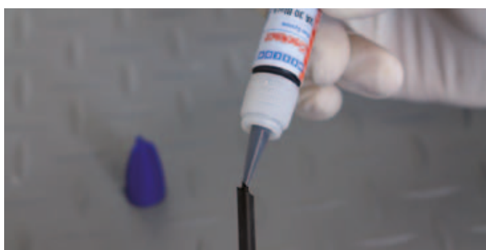
3 Нанесите клей VA 1401 на срез уплотнителя
