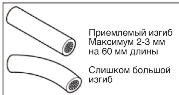
Рисунок 9 Выпрямление провода
