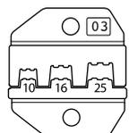
Опрессовка одинарных изолированных и неизолированных втулочных наконечников
