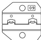
Опрессовка флажковых разъемов в нейлоновом корпусе
