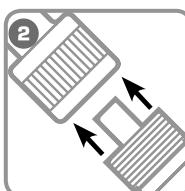
**Присоедините рукав высокого давления (РВД) помпы к клапану гидравлического инструмента**
