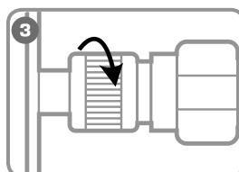
**Плотно затяните гайку БРС, приложив достаточное усилие (от руки) для обеспечения хорошего соединения (без применения слесарного инструмента)**
