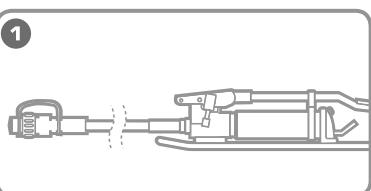
**Установите помпу и ножницы по возможности на ровной, плоской поверхности. Такое положение обеспечит устойчивость во время работы**
