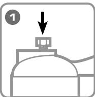
**Установите помпу под углом 30° заливной пробкой вверх и открутите заливную пробку на 2-3 оборота. Пробка должна остьаться в резьбовой части, чтобы масло не разбрзгивалось. Для стравливания воздуха, произвести установку педали в рабочее положение.**
