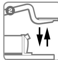
**Произведите 3-5 качков педалью, плотно закрутите заливную пробку и проверьте помпу в работе. При необходимости повторите порядок действий.**
