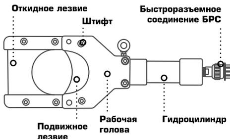
Масло нагнетается в гидроцилиндр и перемещает поршень. Поршень под давлением масла перемещает подвижное лезвие. При сбросе давления возвратная пружина вернет подвижное лезвие в исходное положение
