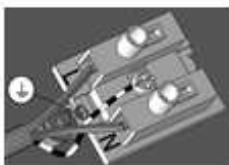
6. Полярність підключення проводів «+» та «-» мережі постійного струму до клем L та N не нормується.
