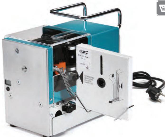
*“Подача в ствольную коробку пулеметных лент емкостью 500/1000 наконечников.”*
